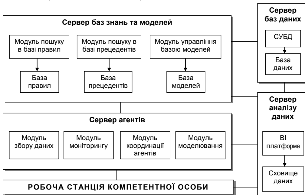
Рис. 3. Розміщення компонент AODSS в апаратно-програмному комплексі
